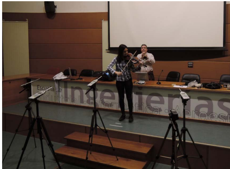
Fig. 3: Posición de los sonómetros en el entorno de los instrumentos
