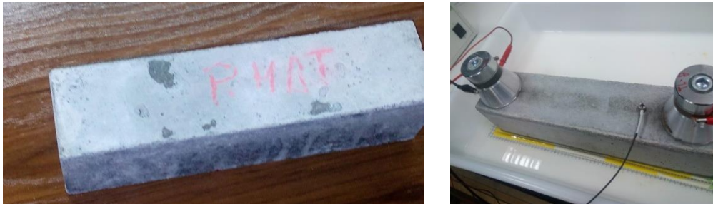
Figura 1. (Izq) Probeta recién salida de la cámara húmeda. (Dch) Probeta con tres transductores instalados (un emisor y dos receptores).
