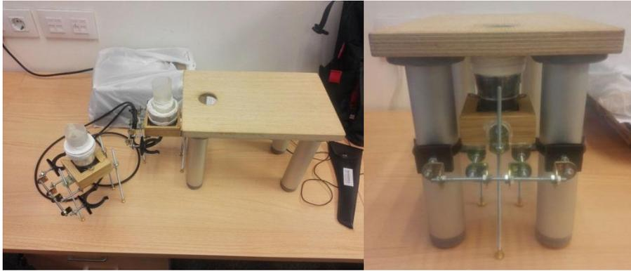
**Figura 4.** Prototipo finalizado, con los soportes de sujeción de los transductores y el horn acoplados.
