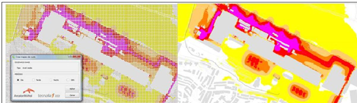
Figura 4 – Creación de mapas de ruido a partir de la malla mediante interpolación
