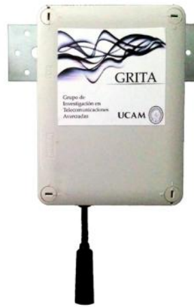
Figura 1. Diseño final del sensor acústico encapsulado en caja estanca para su instalación en exteriores
