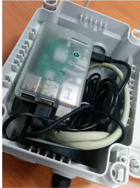
Figura 4. Interior de la caja estanca con la Raspberry Pi en primer plano, el cableado Ethernet y de alimentación, y el splitter debajo de la caja que contiene la Raspberry.
