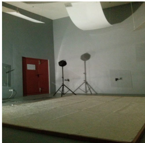
Figura 2. Ensayo de la absorción acústica según procedimiento normalizado (UNE EN ISO 354:2004) en la EPSG-UPV.
