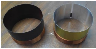
Fase I: Soporte de fibra y de aluminio con fajita y bobina
