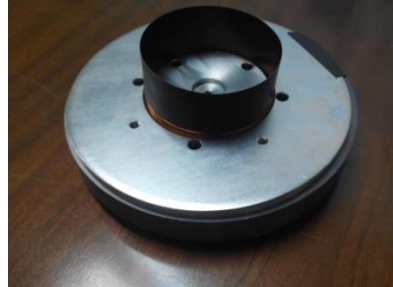
Fase IV: Soporte y bobina con anilla inferior e imán
