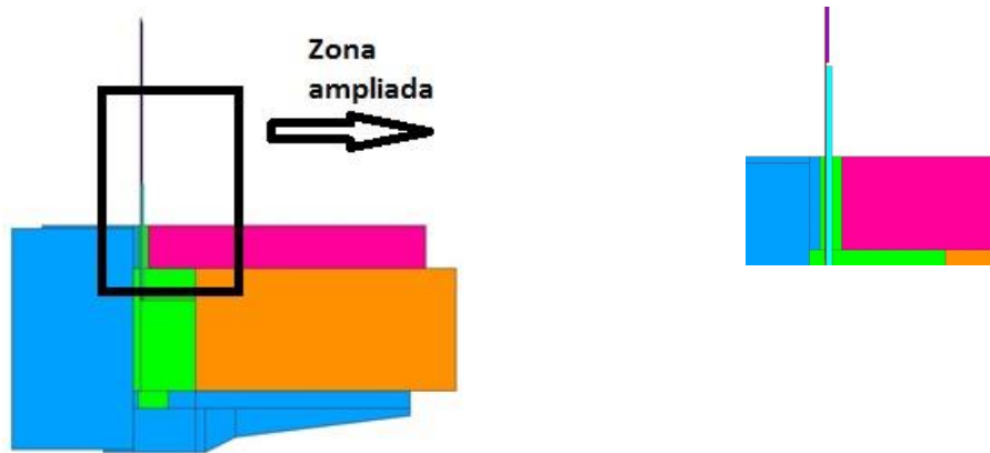
Figura 4: Partes del modelo en elementos finitos. A la derecha se ha ampliado la zona enmarcada para visualizar la bobina, la faja y el entrehierro con aire (color verde)
