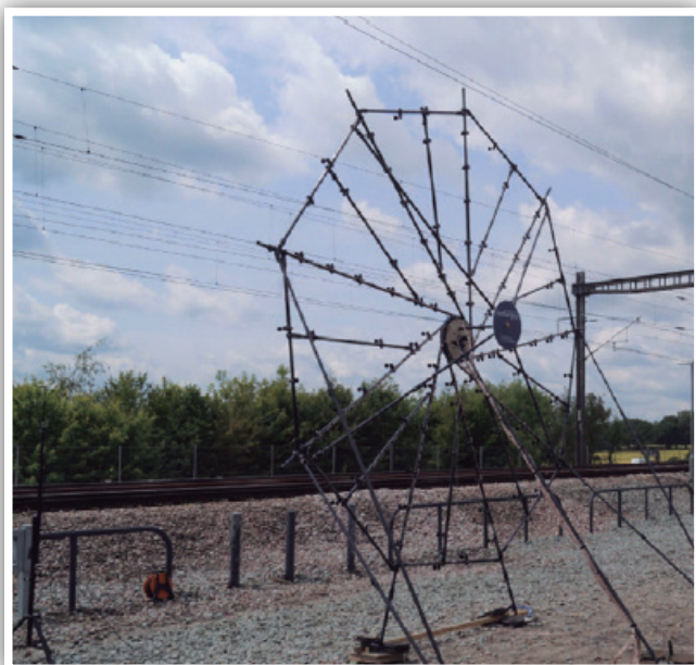
Figura 6. Array de micrófonos utilizado durante medidas de ruido del paso del tren [34].
