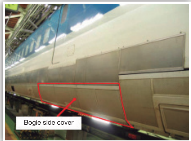
Figura 5. Pantalla instalada en el lateral de la cavidad del bogie [27].
