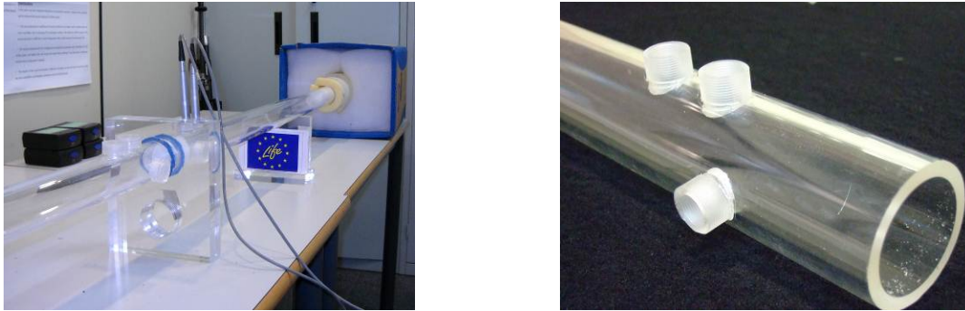
Figura 2- Diseño propio del esquema de la figura 1 para el cálculo de las pérdidas por transmisión. Algún detalle del mismo.
