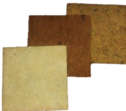
Figura 3. Muestras fabricadas (en sentido ascendente): no tejido de fique, no tejido de coco y muestra en la que se combinan ambas fibras, fique y coco.
