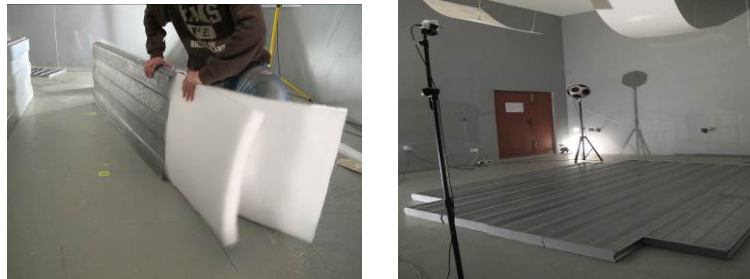
Figura 10. Imágenes de montaje en la cámara reverberante de la EPSG.
