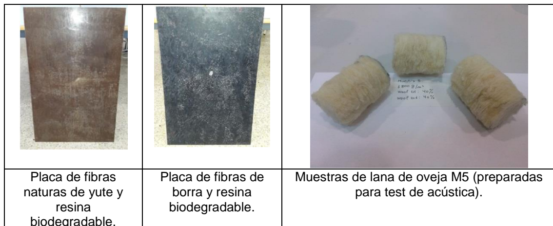
Figura 1. Placas de Green composite y absorbente estudiadas en este trabajo.
