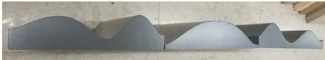
Figura 5 – Os três provetes utilizados para a validação experimental, com altura máx. idêntica de 0.15 m.
