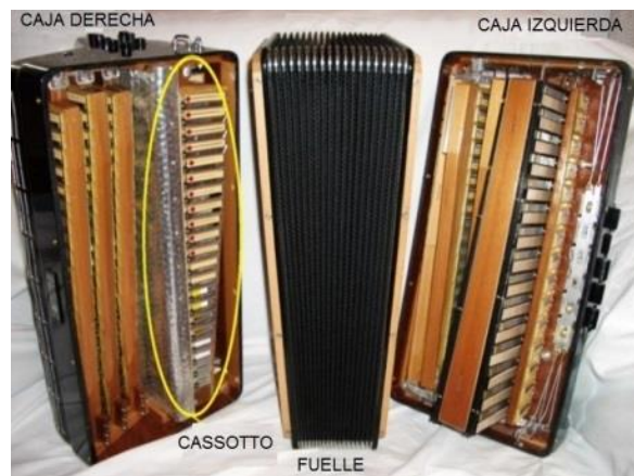
Figura 2: Vista frontal el interior de un acordeón de concierto.
