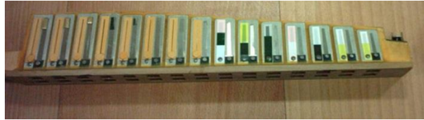
Figura 1: Bloque de lengüetas de acordeón. Las tres lengüetas de la izquierda están cargadas.
