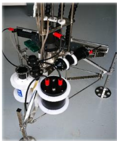
Fig. 7. Mini Perfilador MP4. Vista del módem y del cilindro estanco.
