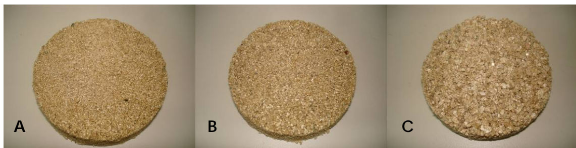
Figura 1. Detalle de las muestras con diferentes granulometrías empleadas; (A) 0.5-2.0 mm, (B) 0.5-3.0 mm y (C) 1.0-4.0 mm.
