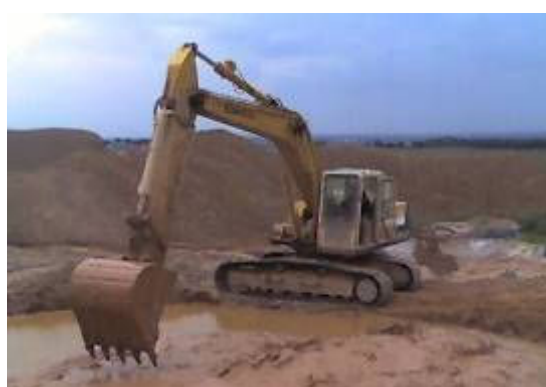
Figura 9 – Pá Giratória movimentando lamas
