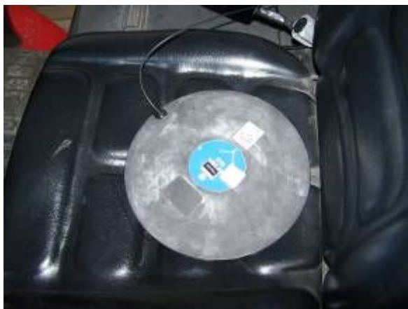
Figura 2 – Localização do acelerómetro
