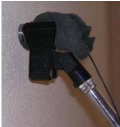
Figura 3: Colocación del acelerómetro en un elemento constructivo vertical flanco de la medianera
