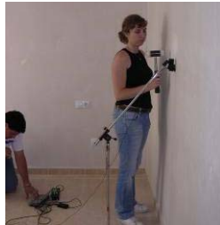
Figura 4: Medición de la amplitud de aceleración de un elemento constructivo excitando dicho elemento con martillo.
