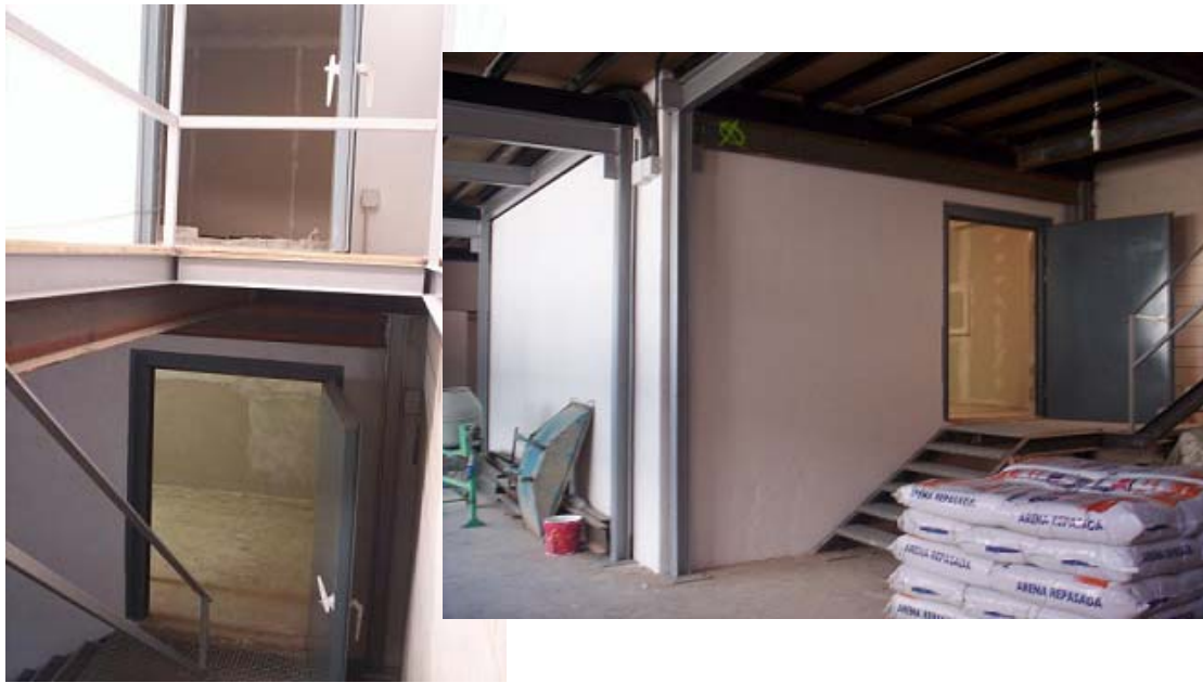
Figura 1. Cámaras de ensayos 'in situ' de aislamiento a ruido aéreo y de impactos
