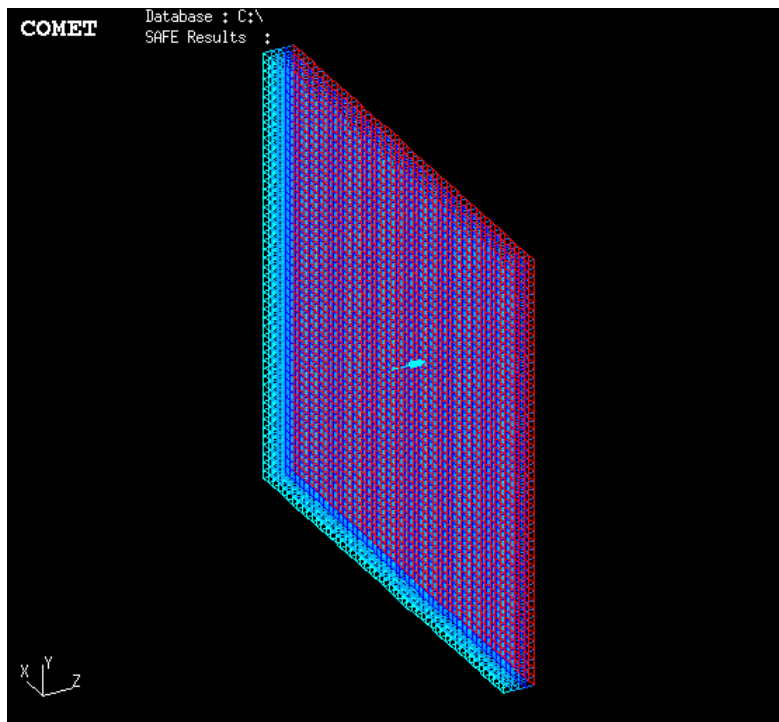
Figura 2. Ejemplo de modelo por Elementos Finitos para predicción de aislamiento
