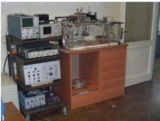
Figura 3. Calibración primaria de hidrófonos sonda
