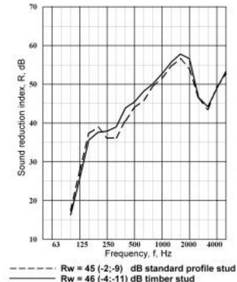
Figure 14: „Screw Position Effect“, vertical distance 69 cm
