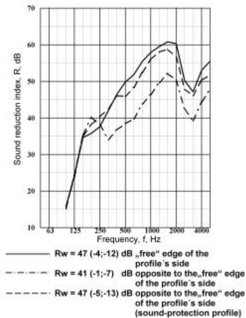
Figure 9: „Screw Position Effect“
