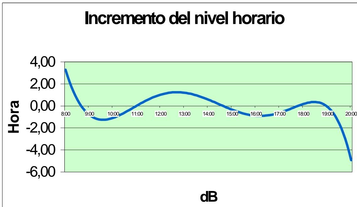
Figura 1. Incremento del Nivel Sonoro Equivalente para un periodo comprendido entre 10 y 60 minutos, respecto al nivel sonoro equivalente diurno (8 a 20 horas), en función del instante de medición.
