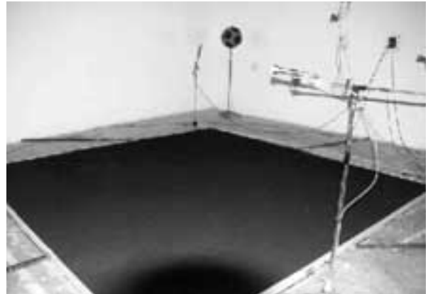
Figura 3. Estudio integral de la absorción acústica de la granza de caucho en cámara reverberante.
