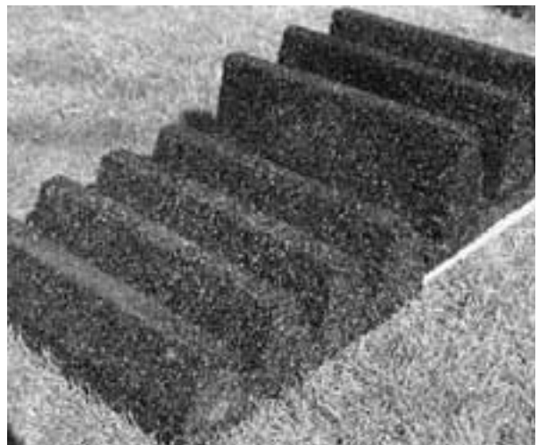
La figura 4. Absorbente de granza de caucho para tratamiento superficial de barreras acústicas.
