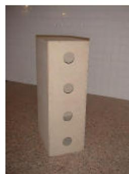
Para los ensayos de coeficiente de absorción se midieron dos conjuntos de resonadores. Uno de ellos formado por botellas ( $f_0$  de 116 Hz) y realizando medidas con grupos de 25, 50 y 100 resonadores. Un segundo sistema se observa en la fotografía superior y se basa en un conjunto de 8 resonadores de madera sintonizados a 90.5Hz.
