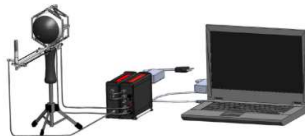
Figura 1. Montaje de medida de la pistola de impedancia
