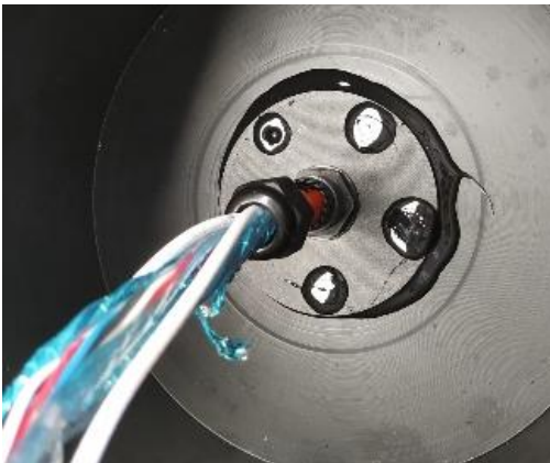
Figura 7. Detalle del acabado hermético de la parte posterior de la caja con el cableado necesario (señal proveniente del amplificador y alimentación del acelerómetro)
