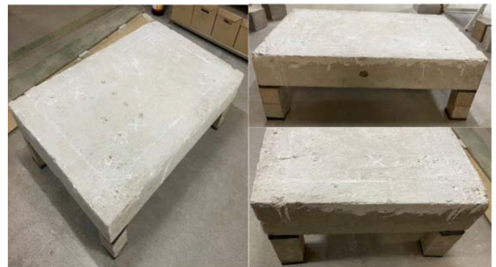
Figura 2. Placa de hormigón según UNE-EN ISO 16251-1
