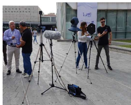
Figura 3. Evaluación objetiva mediante instrumentación, paseos sonoros ISO12913, Elche_2022.
