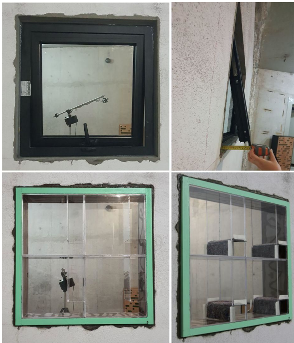
Figura 3. Ventanas colocadas en vano: a) Ventana pivotante: cerrada y abierta b) Estructura de metaventana: mm1.
