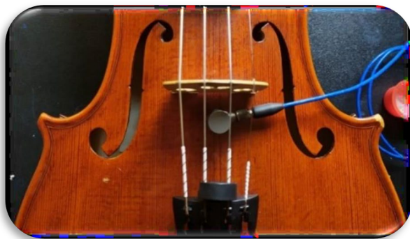
Figura 4. Colocación del acelerómetro en el violín.
